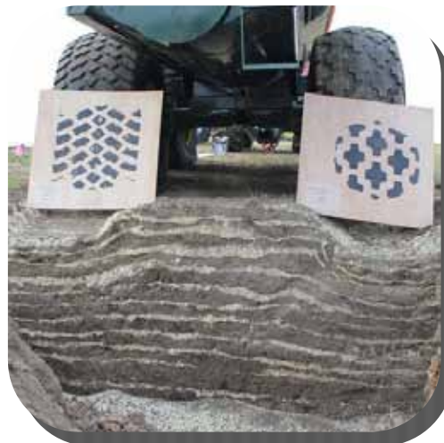
Figure 1. Aires de contact et profils de compactage pour un camion-citerne Husky de 8 000 gallons rempli de fumier au maximum de sa capacité (environ 21 000 lb/pneu) chaussé de pneus à carcasse radiale Alliance Agri-Transport 35,5LR32 sous une pression de 18 lb/po 2 (à gauche) et de pneus à carcasse diagonale Firestone ANS Tractor 35,5L-32 sous une pression de 32 lb/po 2 (à droite). (Courtoisie de Sam Bradshaw, Ontario Pork, et de 2013 North American Manure Expo.)
